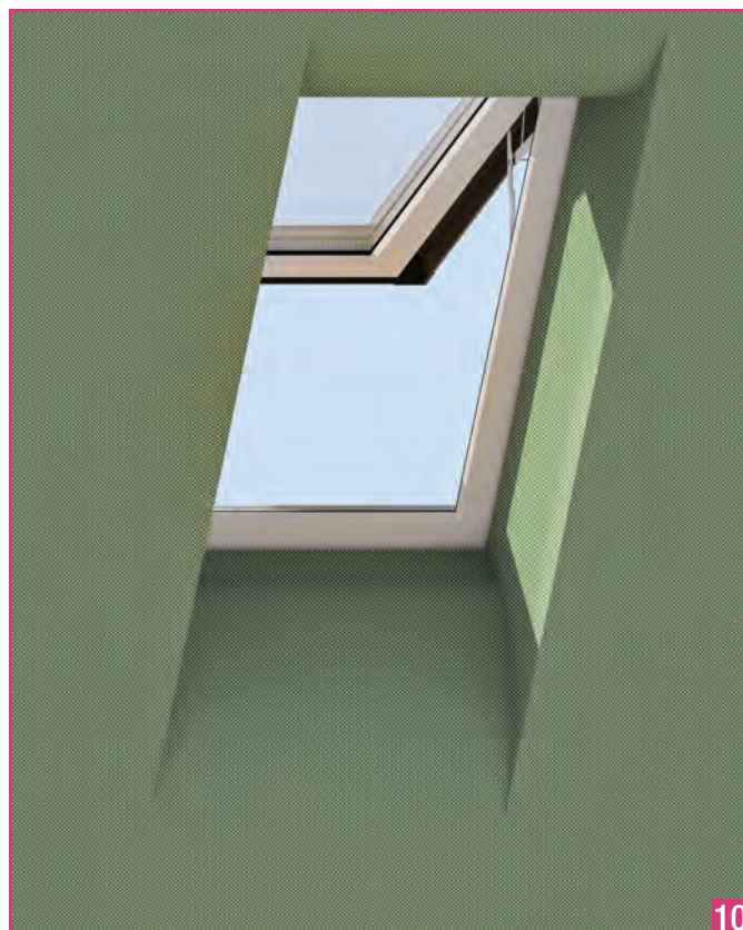
Закрывать утеплитель пароизоляционной мембраной.
