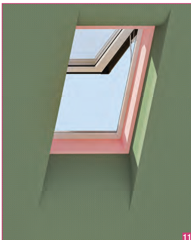
Закрывать примыкания оконной рамы и стропил не паропроницаемым утеплителем (например экструзионным пенополистиролом).
