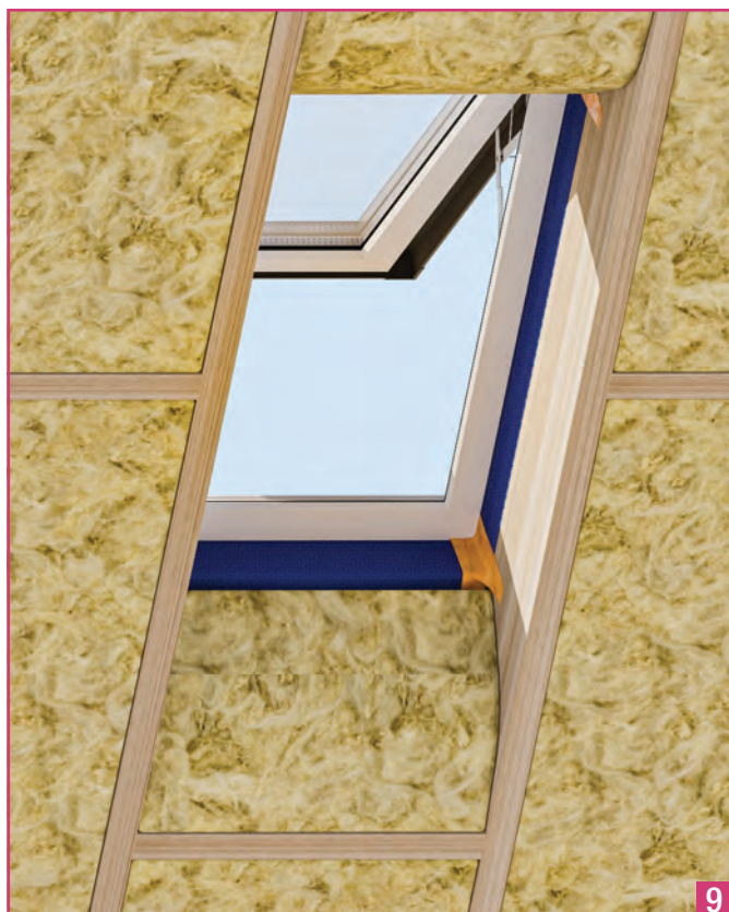
Разместить утеплитель в стропильную систему.
